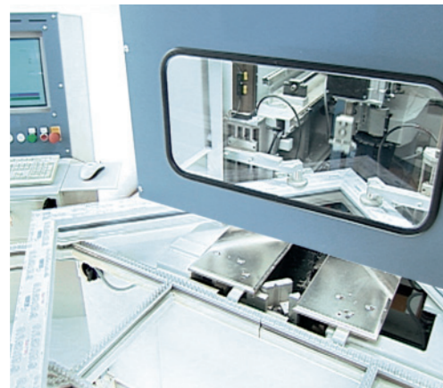
Das Abfräsen der Schweißnähte geschieht in einem unveränderten Prozess.
